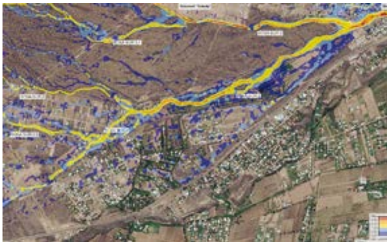
Figura 10. Mapa de velocidades de flujo en Cauce Sosa Sur 2 (TR=50 años) (Fuente: MDLC, 2021)
